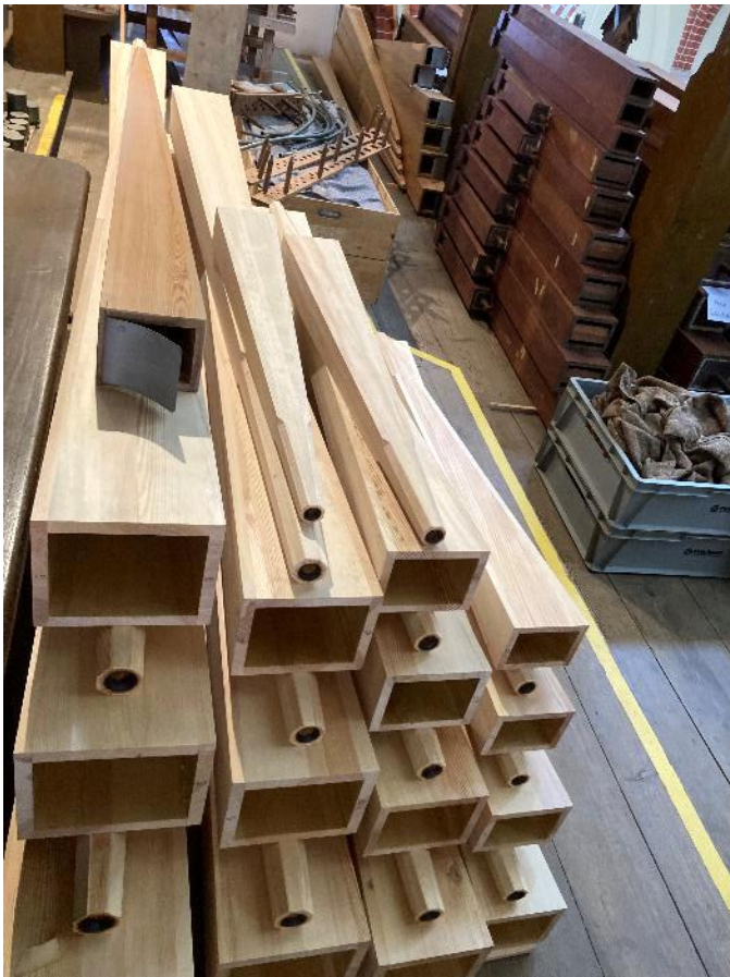
Auf die „Organspende-Zungenstiefel“ kommen diese neue Posaunenbecher, sie sind voluminöser als die bisherigen (einer davon liegt ganz oben)
